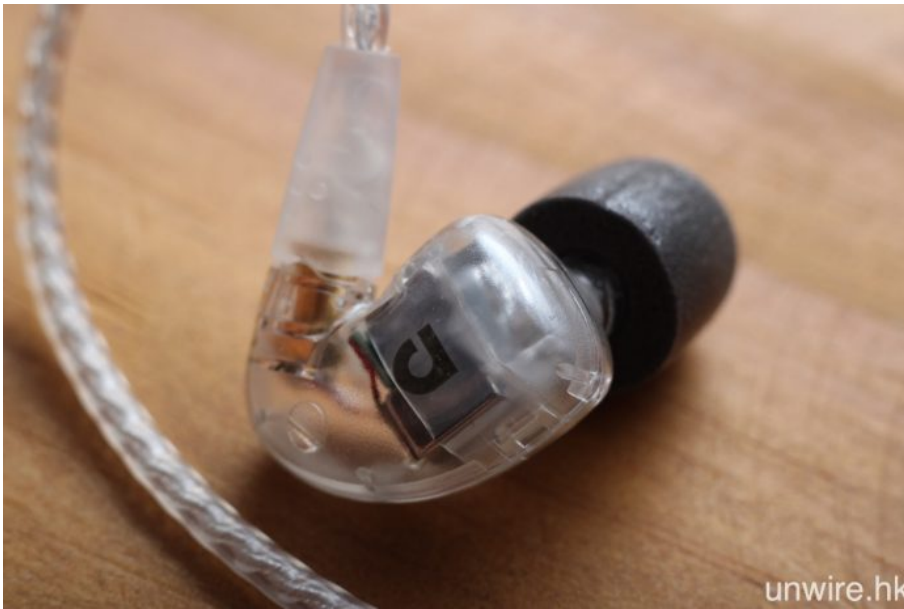
全透明機身可以清晰地觀看到 6 個動鐵單元，與及整齊企理的走線。
